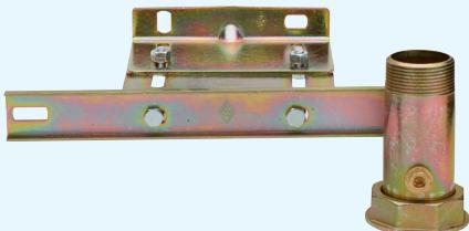
**Traversa in acciaio con canotto filettato UNI EN 10226/1 e presa pressione UNI ISO 228/1 G 1/4", zanca a muro regolabile per contatori G10-G16.**
