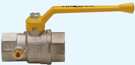
**Valvola a sfera per gas a passaggio totale diritta, post-contatore con punto presa pressione laterale, attacchi F/F e leva in alluminio.**
